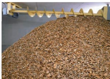
Remplissage du silo par vis horizontale depuis la trémie
